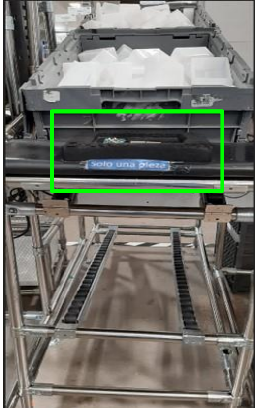
Figura 5.12 Implementación de Poka-Yoke en estaciones de trabajo.
