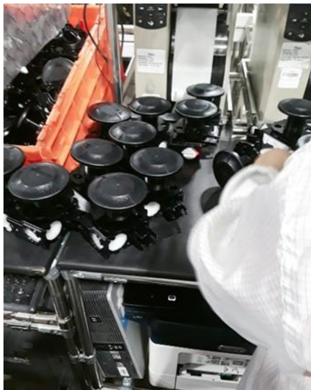
Figura 4.3 Material en exceso en estaciones de trabajo.
